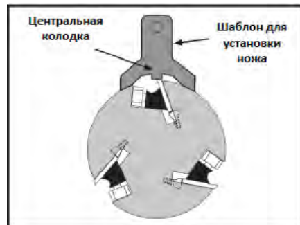
Рис. 16 Правильное положение шаблона для установки ножа
