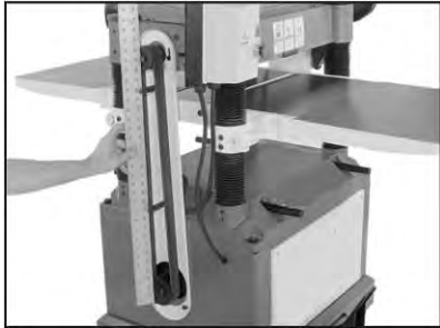
Рис. 30 Проверка правильности положения шкивов
