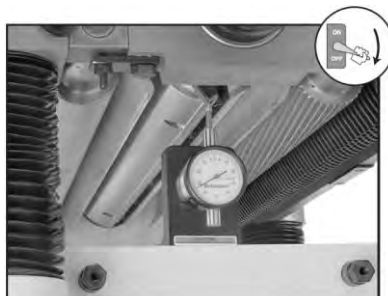
Рис. 23 Использование ротакатора для нахождения НМТ
