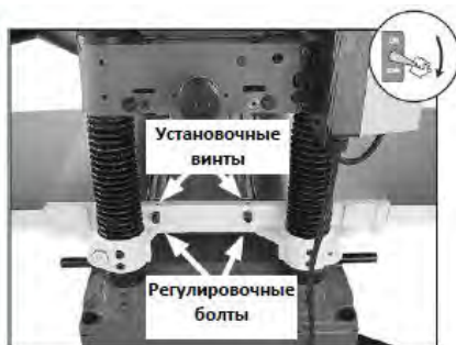
Рис. 14 Регулировка высоты опорных роликов
