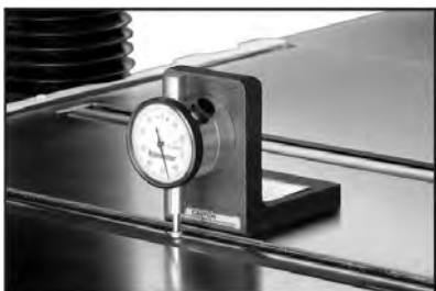
Рис. 22 Инструмент для точной регулировки станка Rotacator
