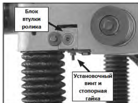
Рис. 24 Блок втулки ролика подачи и регулировка высоты
