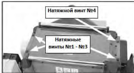
Рис. 26 Виты для регулировки натяжения пружин роликов
