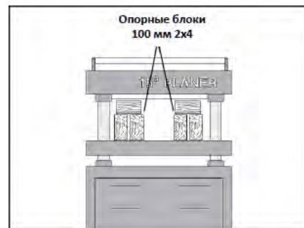
Рис. 24 Расположение опорных блоков
