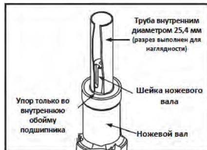
Рис. 30 Установка подшипника
