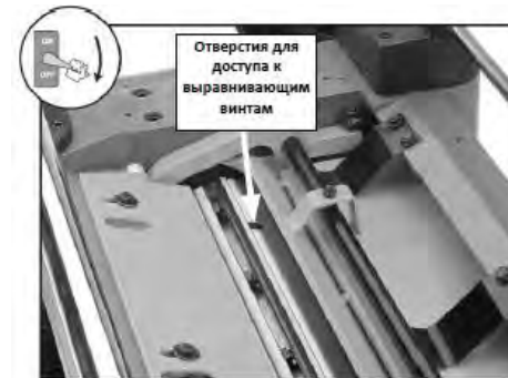
Рис. 17. Отверстия для доступа к выравнивающим винтам в ножевом вале
