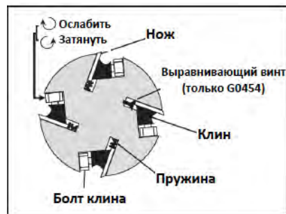
Рис. 15 Компоненты ножевого вала
