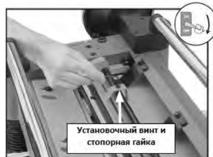
Рис. 25 Регулировка высоты стружколомателя
