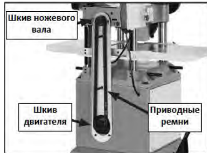
Рис. 19. Ограждение ремней снято
