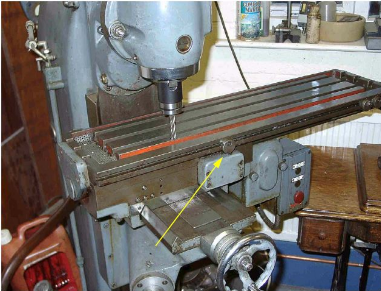
Рисунок 4-10: Фрезер с инструментом в точке X=0 , Y=0 (кулачок находится на концевике)
